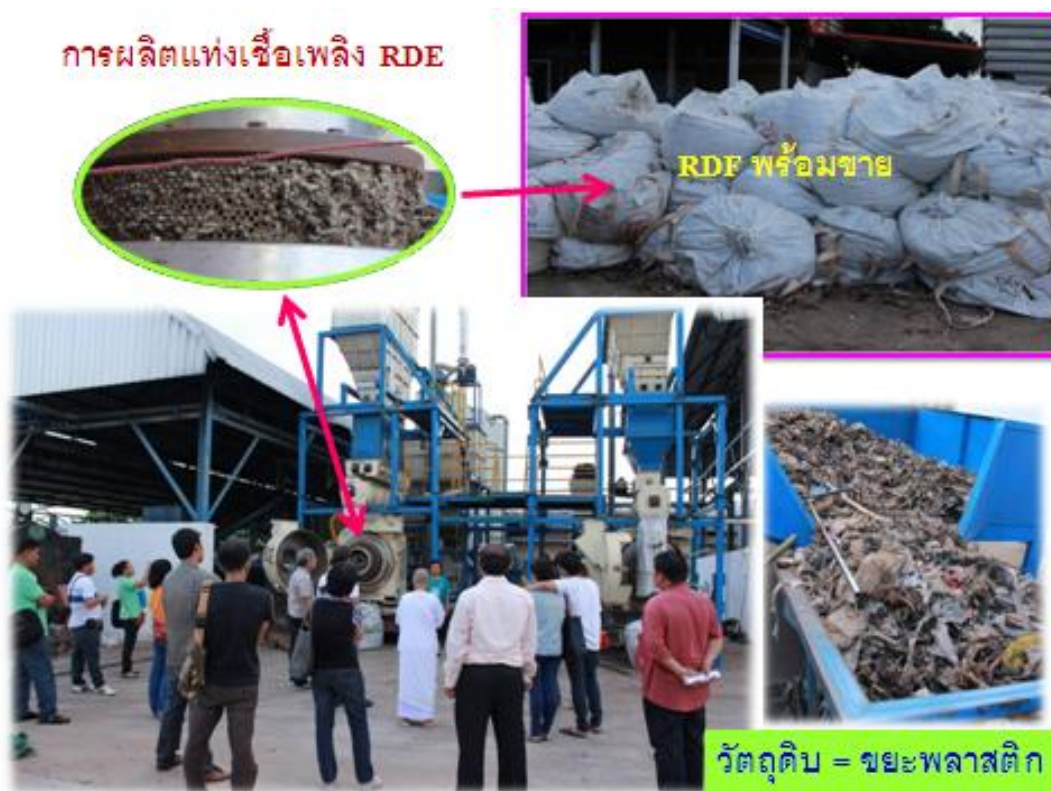
ภาพที่ 4 การผลิตแท่งเชื้อเพลิง RDF จากขยะของมหาวิทยาลัยสุรนารี จ.นครราชสีมา
