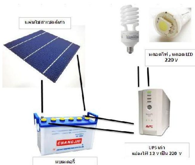
ภาพที่ 11 แผ่นโซลาร์เซลล์เก่า ต่อกับเครื่องสำรองไฟ ของคอมพิวเตอร์ UPS เก่า
