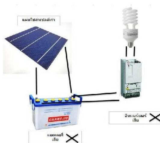
ภาพที่ 9 ชุดอุปกรณ์อินเวอร์เตอร์เสีย หรือ แบตเตอรี่เสีย ทั้งนี้ แผ่นโซลาเซลล์เก่ายังสามารถใช้งานได้
