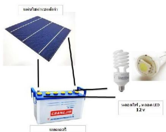
ภาพที่ 12 แผ่นโซลาร์เซลล์เก่า ต่อกับแบตเตอรี่ 12 โวลต์ และชุดหลอดไฟ 12 โวลต์
