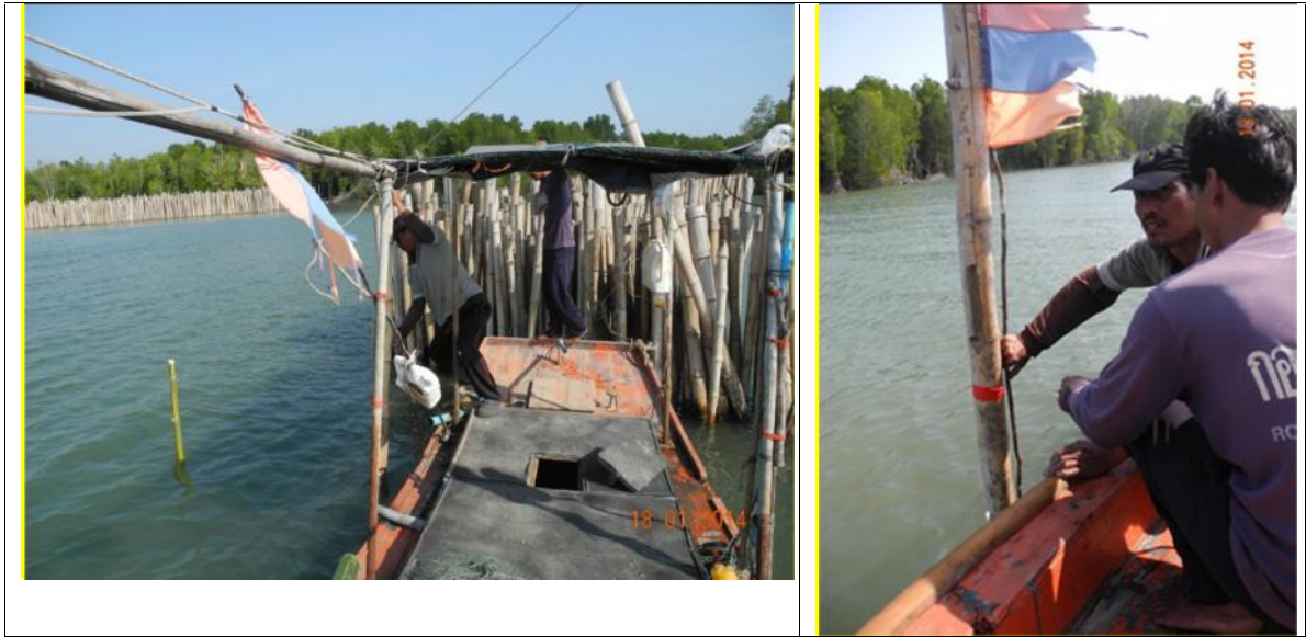
ภาพที่ 2.5.2 นักวิจัยชุมชนหมู่ 3 ติดตั้งไม้วัดระดับการเปลี่ยนแปลงพื้นทะเล เดือนมกราคม 2557
